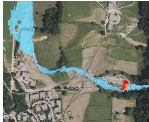
Murmodellierung am Roßbichlbach (Simulation mit RAMMS)
